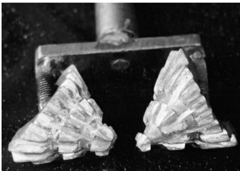
Рис. 1. Опытный образец шарошечного долота для бурения скважины с квадратным поперечным сечением
